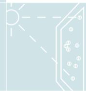
Im ersten Schritt absorbiert die Activ™ Glasoberfläche die ultravioletten Strahlen der Sonne und löst in Verbindung mit Sauerstoff eine chemische Reaktion aus: organische Schmutzpartikel werden aufgespalten und abgelöst.
